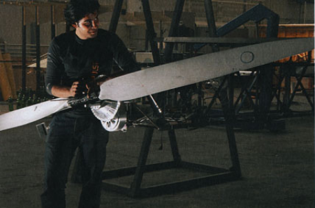
Solide et légère (4,5 kg), l'une des quatre hélices de Solar Impulse montée sur sa gondole.
